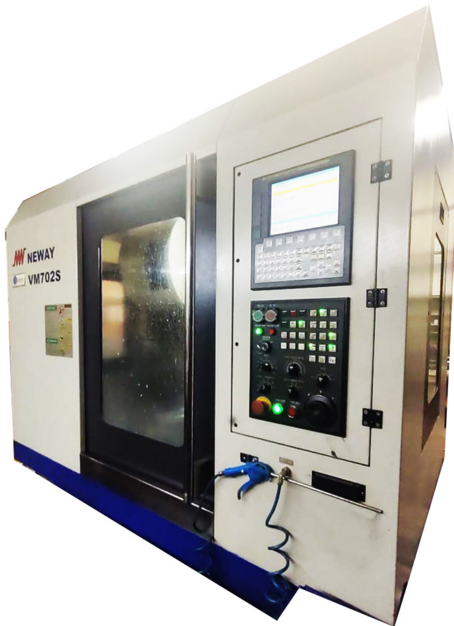
Centro de mecanizado CNC
